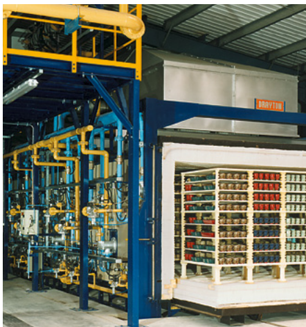
Four à sole mobile pour la céramique fine
