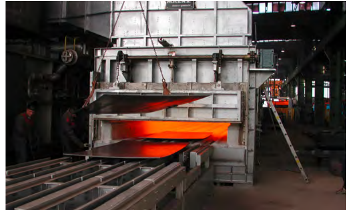
Forno per trattamento termico di lamiere in acciaio
