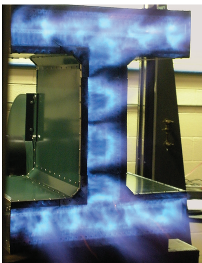
AirHeat v2.00 型号 0600T 燃烧器, 输出功率 50% , 3.0 MM Btu/hr (878kW)。
