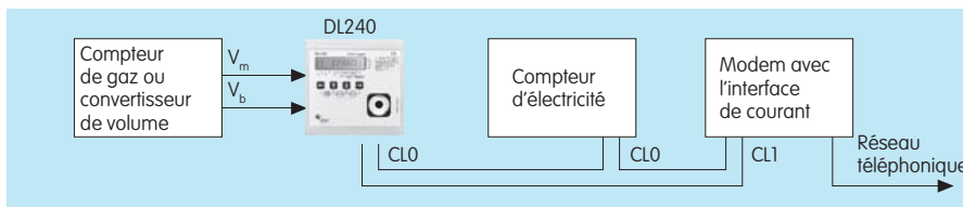
DL240 comme dispositif d'enregistrement pour télétransmission de données connecté avec un compteur électrique à un réseau téléphonique via un modem avec interface CL
