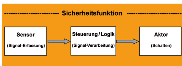
Bild 10: SIL/PL – Level einer Sicherheitsfunktion
