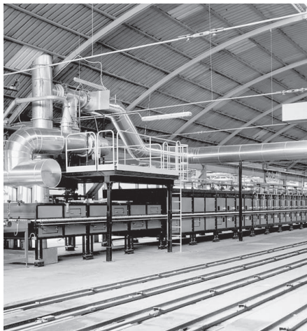
Роликовая печь обжига в керамической промышленности
