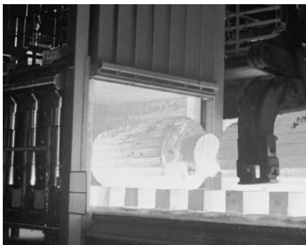
Кузнечная печь с выкатным подом в металлургиче- ской промыш- ленности
