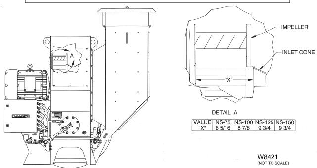
Figure 14. Proper Impeller Position
