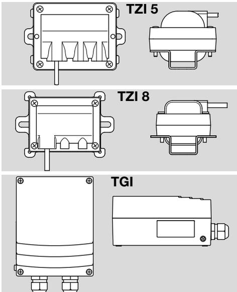
→ Zündtrafo dicht am Brenner positionieren (Zündleitungslänge: max. 5 m, empfohlen  $<$  1 m).
