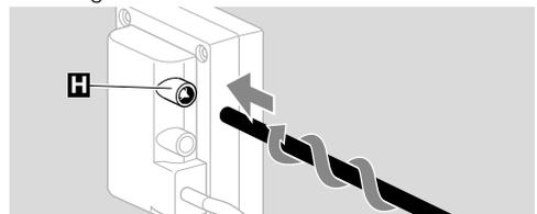
**3** Zündtransformator verdrahten nach Anschlussplan.
