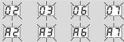
**? Пуск – пламя горит – несмотря на это дисплей мигает и отображает 2 или 3 для запальной горелки/горелки (горелка 1) или 6 или 7 для основной горелки (горелка 2).**
