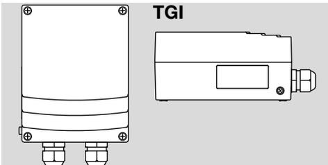
→ Posicionar el transformador de encendido cerca del quemador (longitud del cable de encendido: máx. 5 m, recomendado < 1 m).
