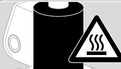
→ Använd en temperaturbeständig kabel (> 80 °C).
