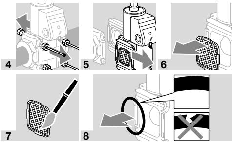
**9** Efter byte av tätningsarna, sätt ihop apparaten i omvänt ordningsföljd.
