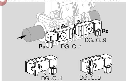
→ Om gastryckvakten byggs in i efterhand, se medföljande bruksanvisning "Gastryckvakt DG..C", kapitel "Montera DG..C.. på gasmagnetventil valVario".
