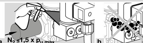
Verificar a estanqueidade da válvula de bypass/gás piloto no lado da entrada e da saída.
