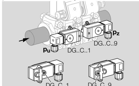
→ Se o pressostato de gás for reequipado, ver as instruções de operação incluídas: "Pressostato de gás DG..C.", capítulo "Montar o DG..C.. na válvula solenoide para gás valVario".
