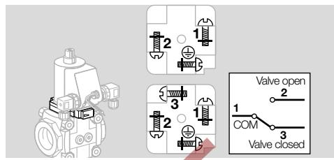
→ Prestar atenção para que o terminal de conexão para o indicador de posição esteja conectado novamente.
