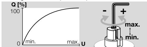
→ A estanqueidade da VAS 1-3 se mantém mesmo quando o parafuso de ajuste for demasiado girado.
