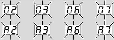
**? Anlauf – Flamme brennt – trotzdem blinkt die Anzeige und zeigt 2 oder 3 beim Zündbrenner/Brenner 1) oder 6 oder 7 beim Hauptbrenner (Brenner 2)?**
