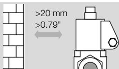
L'appareil ne doit pas être en contact avec une paroi. Écart minimal de 20 mm (0,79").
