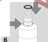
→ Si el presente dispositivo tiene una junta tórica en este punto (flecha), cambiar el actuador como aquí se describe: VAS 1: utilizar todas las juntas del set adaptador del actuador. VAS 2, VAS 3: utilizar la junta pequeña y solo una junta grande del set adaptador del actuador.
