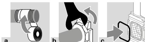
→ Deben estar montados la junta tórica y el tamiz (figura c).
