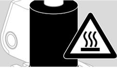
→ Temperaturbeständiges Kabel (> 80 °C) verwenden.
