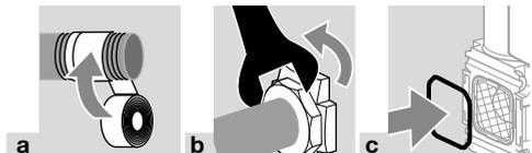
→ O-Ring und Sieb (Bild c) müssen eingebaut sein.
