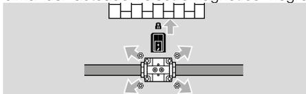
→ La presión de entrada  $p_u$ , así como la presión de salida  $p_d$ , se pueden medir en ambos lados mediante tomas de presión, ver accesorios.
