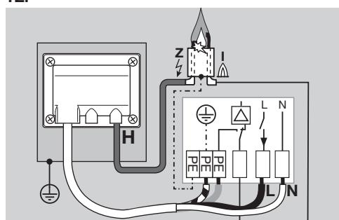
→ При работе по одноэлектродной схеме управления проложите кабель для выравнивания потенциала между горелкой и автоматом управления горелкой.
