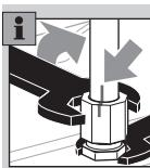
▷ При повторном монтаже накидная гайка устанавливается в первоначальное положение, а затем затягивается еще прибл. на 30°.
