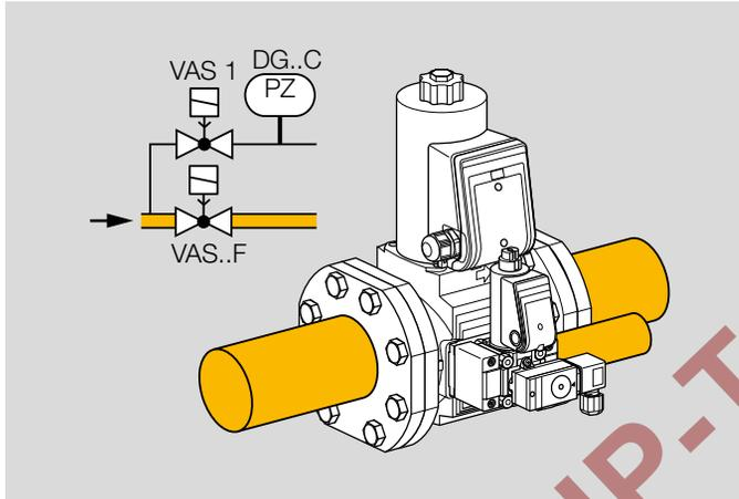
VAS..F..N, schnell öffnend, schnell schließend, VAS 1 als Zündgasventil mit Druckwächter DG..C.
