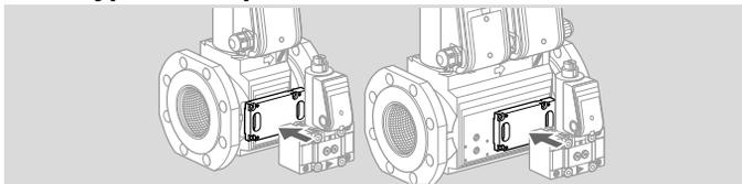
Für den Anschluss des Bypass-/Zündgasventils VAS 1.
