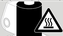
→ Χρησιμοποιείτε καλώδιο ανθεκτικό στις υψηλές θερμοκρασίες (> 80 °C).
