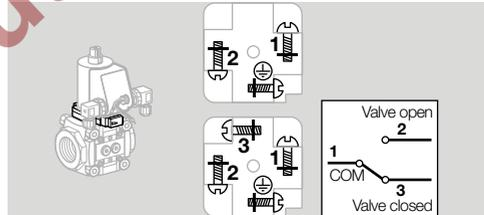
→ Se till att anslutningsklämman för lägesindikatorn är ansluten igen.
