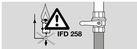
→ IFD 244 : l'IFD 244 procède à un redémarrage et ensuite à une mise à l'arrêt. IFD 258 : si le commutateur est réglé sur redémarrage, l'IFD 258 essaie ensuite de démarrer, puis procède à une mise à l'arrêt. Lors de la mise à l'arrêt, les vannes gaz sont mises hors tension. Le contact d'indication de défaut entre les bornes (IFD 258 : **8 et 9**, IFD 244 : **7 et 8**) se ferme. L'affichage clignote et indique l'état actuel du programme.
