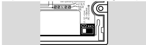
→ En pré-réglage usine, l'IFD 258 est réglé sur arrêt immédiat.
