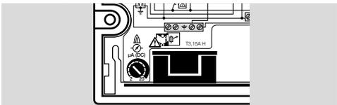
→ Le fusible ne protège que la sortie d’allumage ! Après un court-circuit au niveau de la sortie d’une vanne, un fusible situé à l’intérieur de l’appareil se déclenche et ne peut pas être changé. Expédier l’appareil au fabricant pour contrôle.
