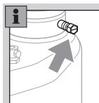
▷ K povoleniu / utiahnutiu skrutky na mernom hrdle použiť otvorený kľúč na skrutky o veľkosti 10 mm.
