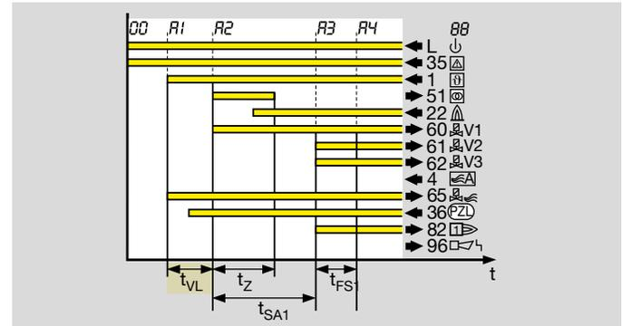
Nach Anlegen des Anlaufsignals (9) und erfolgreich abgelaufener Fremdlichtprüfung und Ruhekontrolle wird das Luftventil geöffnet. Nach Ablauf der parametrierbaren Luftvorlaufzeit  $t_{VL}$  beginnt der Anlauf des Brenners ohne Unterbrechung der Luft.
