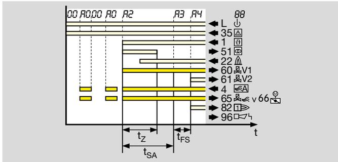
Der Luftfaktor kann über den Eingang an Klemme 4 während des Anlaufs extern angesteuert werden. Dazu muss Parameter A048 = 0 eingestellt sein, siehe dazu Seite 91 (Luftfaktorsteuerung).
