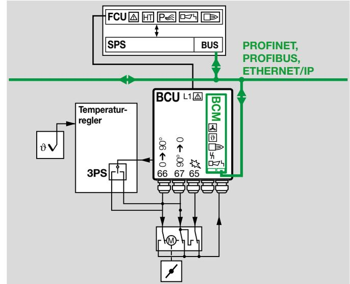
Alle Netzwerkkomponenten, die das Automatisierungssystem und die Feldgeräte verbinden, müssen für den entsprechenden Feldebeneinsatz zertifiziert sein.
