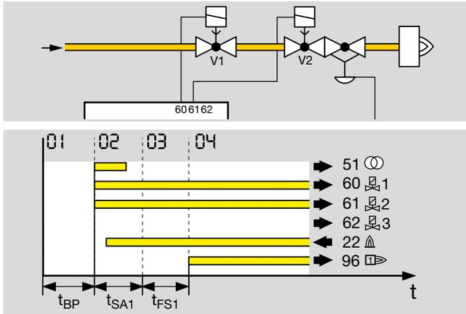
Parameter A078 = 1: Brenner 1 mit Zündgas. Für einen Brenner mit Zündgasventil sind drei Ventile (V1, V2, V3) vorgesehen. Diese werden an die Ventilausgänge (Klemmen 60, 61, 62) angeschlossen. Zum Starten des Brenners öffnen die Ventile V1 und V3. Der Brenner wird über das Ventil V3 mit einer begrenzten Zündleistung angefahren. Nach Ablauf der Sicherheitszeit  $t_{SA1}$  (Programmschritt 02)
