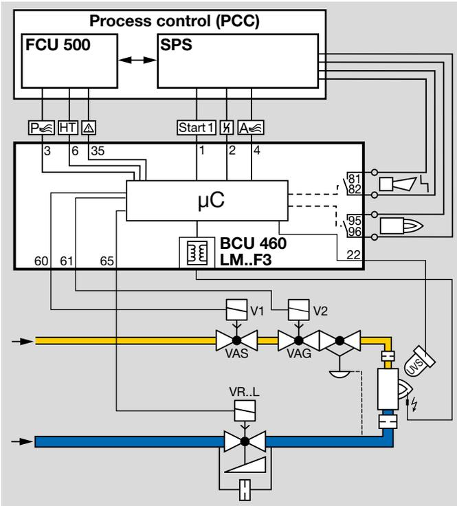
Zum Spülen, Kühlen oder zum Starten des Brenners steuert die BCU mit LM..F3 ein Luftventil an. Über das Luftventil wird die notwendige Luftleistung freigegeben.
