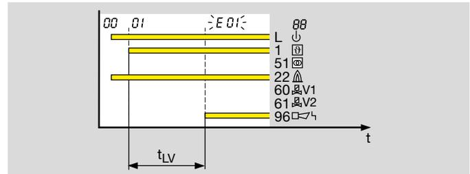
Die Fremdlichtprüfung des Brenners ist immer bis zur Freigabe des Ventils V1 aktiv.
