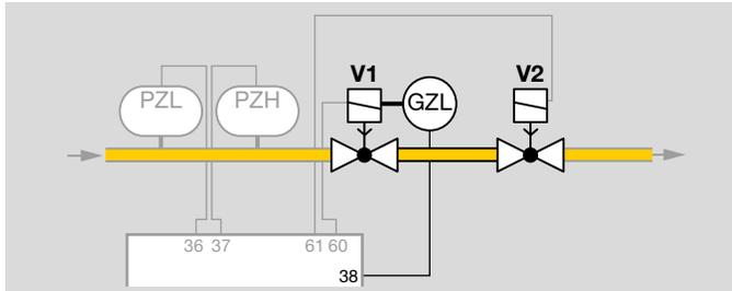
Durch die Überprüfung der Geschlossenstellung mit Hilfe der Proof-of-Closure-Funktion ist die BCU gemäß den Anforderungen der NFPA 85 (Boiler and Combustion Systems Hazards Code) und NFPA 86 (Standard for Ovens and Furnaces) konform.
