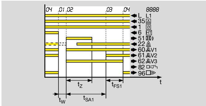
Die BCU schaltet den Brenner ab und läuft neu an mit Fremdlichtüberwachung (empfohlen bei UV-Überwachung mit UVS).
