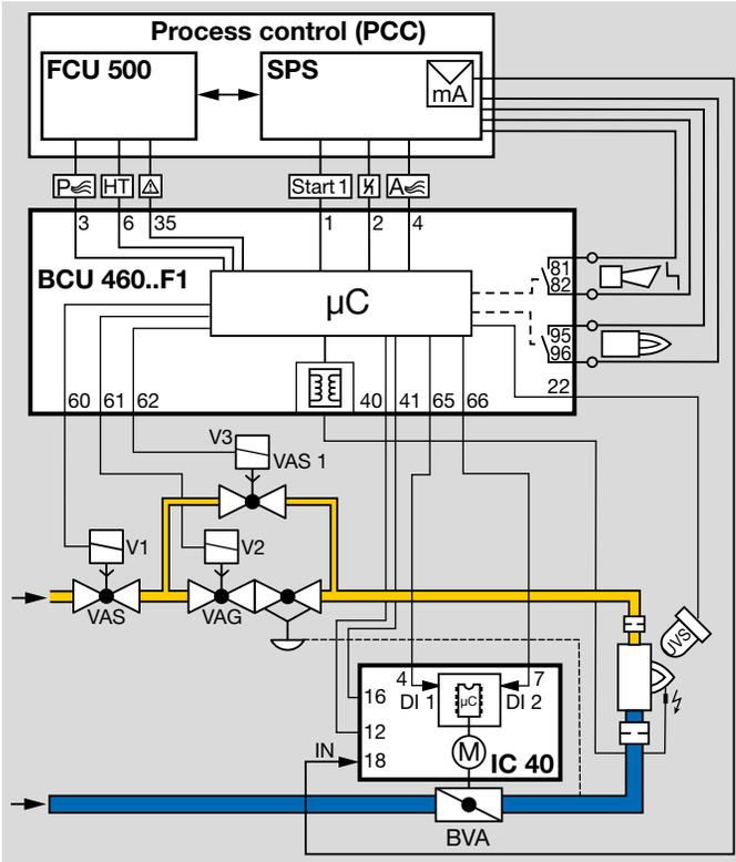
Die zentrale Steuerung startet die Vorspülung. Der Eingang DI 2 wird über den Luftventilausgang der BCU aktiviert und fährt die Drosselklappe BVA in Vorspülstellung.
