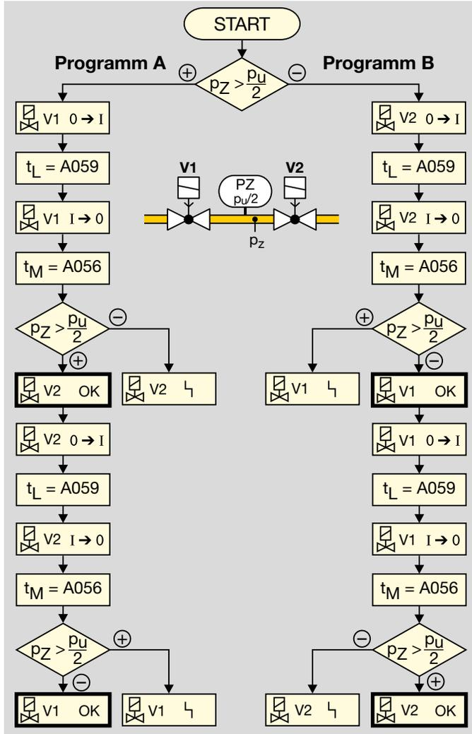
Die Dichtheitskontrolle startet mit Abfrage des externen Druckwächters:
