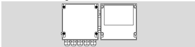
BCU mit vier Schrauben  $\varnothing$  4 mm, Länge mindestens 15 mm, anschrauben.
