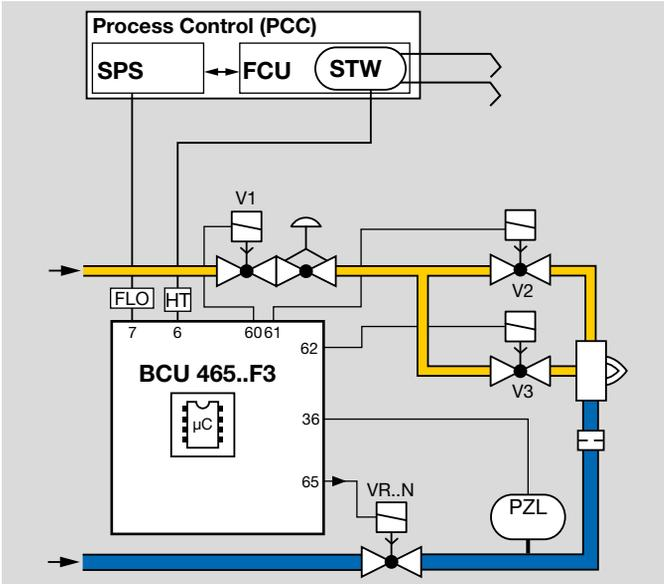
Im Flammenbetrieb ( $> 850\text{ °C}$ ) wird der Brenner konventionell mit der über Parameter A036 festgelegten Luftvorlaufzeit  $t_{VL}$  gestartet.
