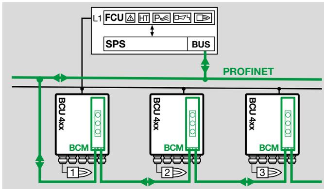
Die Grundfunktion der Feldbuskommunikation ist der Datenaustausch von Prozess- und Bedarfsdaten zwischen einem Controller (z. B. SPS) und mehreren dezentralen Devices (z. B. BCM mit BCU).
