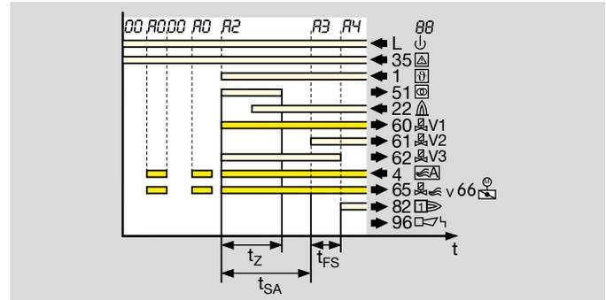
Der Luftfaktor öffnet gleichzeitig mit der 1. Gasstufe (mit V1).
