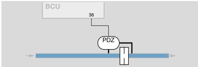
Bei aktivierter Luftströmungsüberwachung wird auch die Ruhelage des Druckwächters (PDZ) zur Luftströmungsüberwachung kontrolliert.
