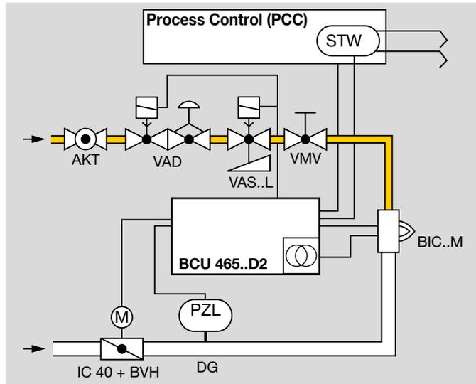
Für einen sicheren Brennerbetrieb mit Low-NO<sub>x</sub>-Betrieb ist ein Brenner BIC..M in Verbindung mit einer Brennersteuerung BCU..D2 notwendig.
