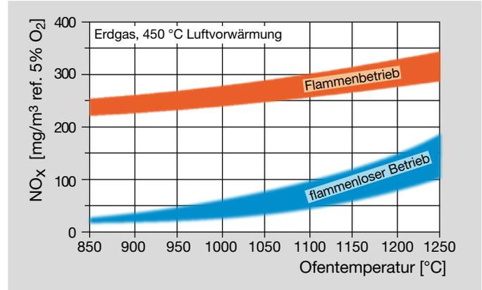
Im flammenlosen Betrieb können die NO<sub>x</sub>-Werte auch bei 1200 °C Ofenraumtemperatur und 450 °C Warmluft ohne aufwändige zusätzliche Verrohrungen auf unterhalb von 150 mg/m<sup>3</sup> (bei 5 % O<sub>2</sub>) gesenkt werden. Der hohe Austrittsimpuls und die Rundum-Taktsteuerung ermöglichen eine vorteilhafte Temperatureinheitlichkeit.
