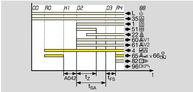
Diese Einstellung in Verbindung mit Parameter A049 = 0, siehe Seite 92 (Luftfaktor beim Anlauf extern ansteuerbar), wird bei Brennern benötigt, an denen das Gas/Luft-Verhältnis über einen pneumatischen Verbund geregelt wird und die in Kleinlast gestartet werden müssen, z. B. an zweistufig geregelten Brennern, siehe Seite 11 (Zweistufig geregelter Brenner). Hierbei muss die Ansteuerung des Luftfaktors während des Brennerstarts über den Eingang an Klemme 4 verhindert werden.
