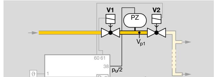
Die erforderliche Messzeit zur Dichtheitsprüfung von  $V_{p1}$  kann über den Parameter A056 eingestellt werden. Einstellbar sind 3 bis 3600 s.
