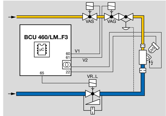
Für langsam öffnende und schließende Luftventile kann über Parameter A042 (Laufzeit) das Verhalten so angepasst werden, dass das System in die Zündposition gefahren werden kann, bevor gestartet wird, siehe Seite 89 (Laufzeit). Um das Verhalten anpassen zu können, muss Parameter A041 (Laufzeitauswahl) = 1 eingestellt sein.
