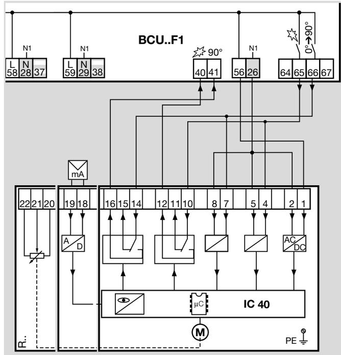
Mit dem Stellantrieb können die Positionen für maximale Leistung und Zündleistung angefahren werden. Das Erreichen der Position für maximale Leistung wird über Klemme 41 abgefragt. Die Position für die Zündleistung wird über
