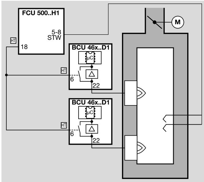
In Hochtemperaturanlagen (Temperatur > 750 °C) kann die Flamme indirekt über die Temperatur überwacht werden. Solange die Temperatur im Ofenraum unter 750 °C liegt, muss die Flamme konventionell überwacht werden.
