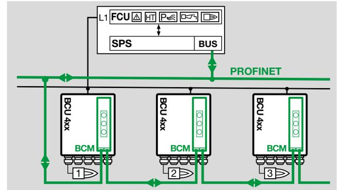
Das Bussystem überträgt vom Automatisierungssystem (SPS) die Steuersignale zur BCU/BCM zum Starten, Entriegeln, zur Luftventilsteuerung, zum Spülen des Ofens oder zum Kühlen und Heizen während des Betriebes. In Gegenrichtung übermittelt es Betriebszustände, die Höhe des Flammenstroms und den aktuellen Programmstatus.
