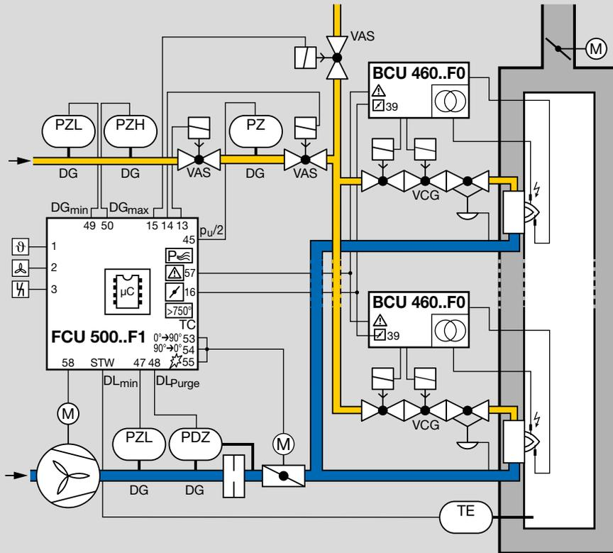
Die zentralen Sicherheitsfunktionen wie Vorspülung, das Anfahren der Zündstellung über eine Drosselklappensteuerung, Dichtheitsprüfung, Strömungs- und Druckwächterabfrage ( $Gas_{min.}$ ,  $Gas_{max.}$ ,  $Luft_{min.}$ ) werden mit der FCU 500 realisiert. Die Leistungsverstellung erfolgt stufenlos durch Ansteuerung des Stellgliedes (analog oder 3-Punkt-Schritt).
