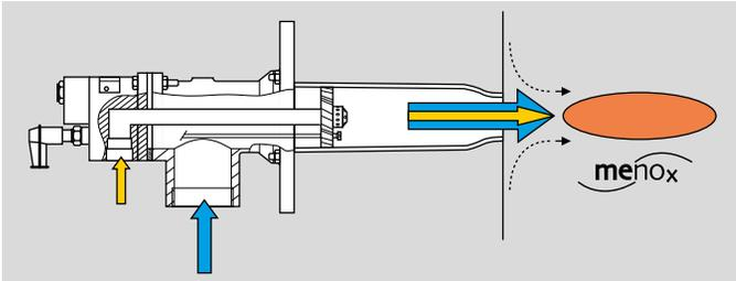
Gas und Luft werden über dieselben Anschlüsse wie im Flammenbetrieb zugeführt. Es erfolgt keine Zündung im Brennerrohr. Die Verbrennung wird in den Brennraum verlagert. Oxidationsreaktionen laufen ohne sichtbare Flamme ab. Verglichen mit dem konventionellen Flammenbetrieb ist
