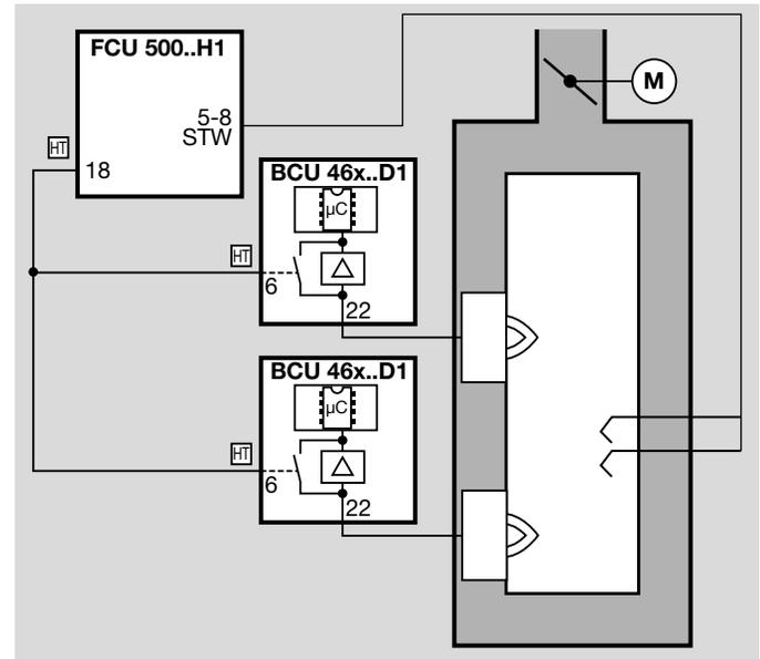
Beim Ansteuern des HT-Eingangs (Klemme 6) geht die Brennersteuerung in den Hochtemperaturbetrieb, das heißt: **Die BCU arbeitet ohne Auswertung des Flammensignals. Die Sicherheitsfunktion der geräteinternen Flammenüberwachung ist außer Kraft gesetzt.**
