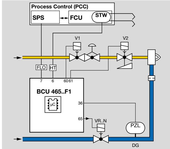
Der Hochtemperatur- und der Eingang für flammenlosen Betrieb (Klemme 6 und 7) müssen ein Signal erhalten, damit auf flammenlosen Betrieb umgeschaltet wird. Der Zeit-
