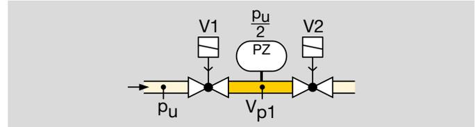
Die europäischen Normen EN 746-2 und EN 676 fordern Dichtheitskontrollen bei einer Leistung über 1200 kW (NF-PA 86: ab 117 kW oder 400.000 Btu/h).
