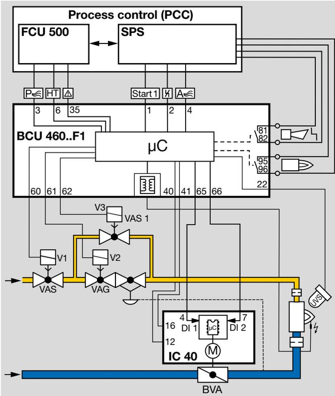
Die zentrale Steuerung startet die Vorspülung. Der Eingang DI 2 wird über den Ausgang an Klemme 66 der BCU aktiviert und fährt die Drosselklappe BVA in Vorspülstellung.
