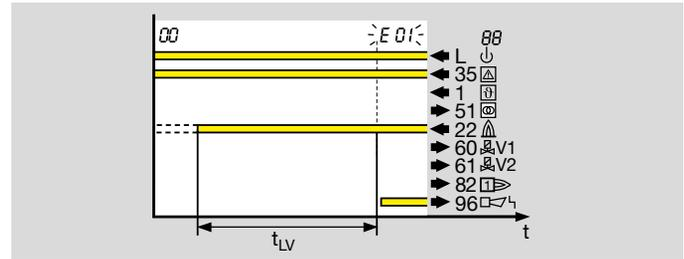
Fremdlichtprüfung im Anlauf (Parameter A003 = 1):
