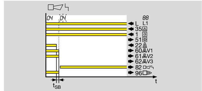
Bei einem Flammenausfall aus dem Betrieb erfolgt eine Sicherheitsabschaltung mit anschließender Störverriegelung.
