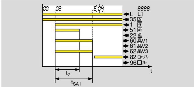
Bildet sich während des Anlaufs keine Flamme, sodass am Ende der Sicherheitszeit  $t_{SA1}$  kein Flammensignal erkannt wird, führt dies zur Sicherheitsabschaltung mit anschlie-
