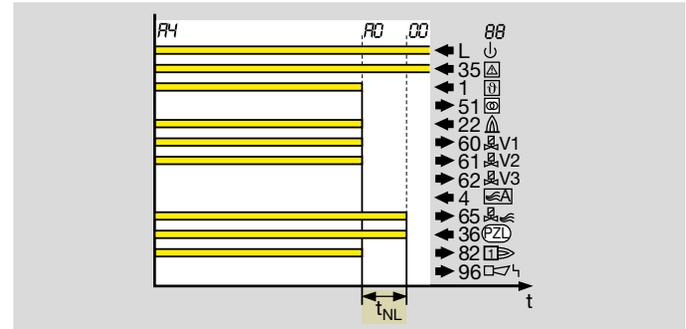
Fällt während des flammenlosen Betriebs das Anlaufsignal (9) nach einer Regelabschaltung ab, bleibt der Aktor (Luftventil, Stellantrieb) für die parametrisierte Nachlaufdauer  $t_{NL}$  (0 bis 60 s) geöffnet. Nach Ablauf der Nachlaufdauer  $t_{NL}$  schließt die Brennersteuerung den Aktor.
