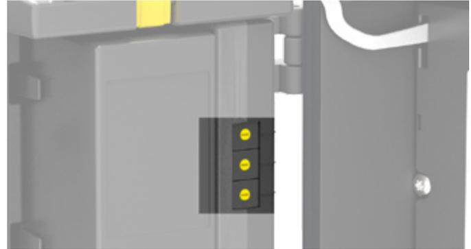
*Kodierschaltereinstellung: Oberer Schalter (S1) =  $10^2$  (Hunderter), mittlerer Schalter (S2) =  $10^1$  (Zehner), unterer Schalter (S3) =  $10^0$  (Einer)*
