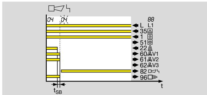
Nach einem Flammenausfall aus dem Betrieb oder einer Unterbrechung der Sicherheitsstromeingänge wird innerhalb der Sicherheitszeit  $t_{SB}$  die Brennstoffzufuhr unterbrochen.
