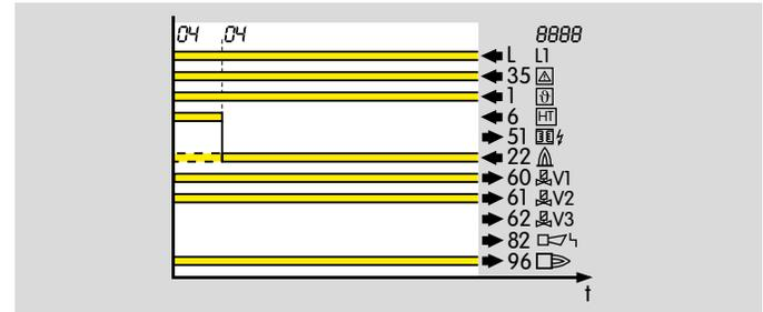
Der Brenner bleibt in Betrieb und die BCU überwacht wieder die Flamme (empfohlen bei Ionisationsüberwachung oder UV-Überwachung mit UVC).
