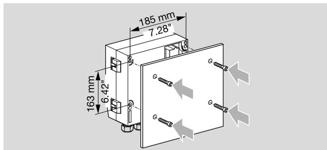
Weitere Befestigungsmöglichkeiten mittels Befestigungsset oder Außenbefestigung, siehe Seite 124 (Befestigungsset) oder Seite 124 (Außenbefestigung)
