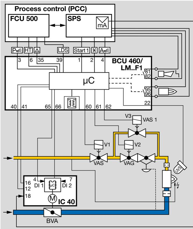
Zum Spülen, Kühlen oder zum Starten des Brenners steuert die BCU mit LM..F1 über die Ausgänge für die Leistungssteuerung (Klemmen 64 bis 67) ein Stellglied an. Das Stellglied fährt die für die jeweilige Betriebssituation notwendige Position an.
