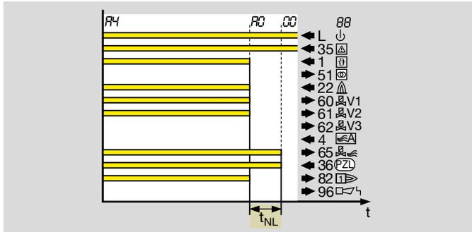
Mit Abfall des Anlaufsignals ( $\theta$ ) nach einer Regelabschaltung bleibt das Luftventil für die parametrisierte Zeit (0 bis 60 s) geöffnet. Nach Ablauf der Nachlaufdauer  $t_{NL}$  schließt die Brennersteuerung den Aktor (Luftventil, Stellantrieb).
