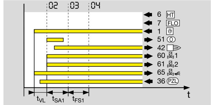
Die Umschaltung vom Flammen- in den flammenlosen Betrieb erfolgt über die mit Parameter A064 gewählte Einstellung sofort oder mit dem nächsten Brennerstart. Um in den flammenlosen Betrieb zu kommen, müssen das HT-Signal vom STW (Klemme 6) sowie das Signal für den flammenlosen Betrieb (FLO) von einer separaten Steuerung (Klemme 7) an der BCU anliegen.
