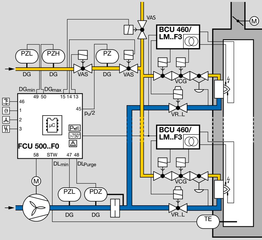
Für Prozesse, die einen Regelbereich größer 10:1 erfordern und/oder die für die Temperaturgleichmäßigkeit eine starke Umwälzung der Ofenatmosphäre erfordern, z. B. Wärmebehandlungsöfen mit niedriger und mittlerer Temperatur in der Metallindustrie.
