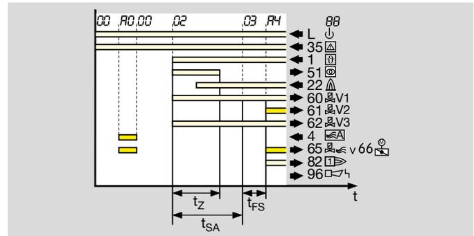
Der Luftfaktor öffnet gleichzeitig mit der 2. Gasstufe/Betrieb.
