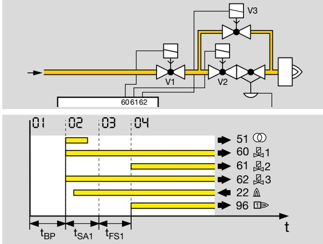
Zum Starten des Brenners öffnen die Ventile V1 und V3. Der Brenner wird über das Ventil V3 mit einer begrenzten Zündleistung angefahren. Nach Ablauf der Flammenstabilisierungszeit  $t_{FS1}$  öffnet das Ventil V2 zur Freigabe der 2. Gasstufe.
