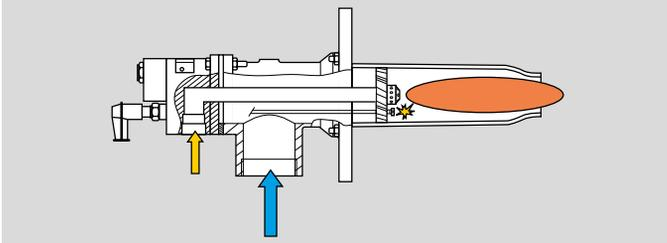
Das zündfähige Gas-Luft-Gemisch wird mit einem elektrischen Zündfunken entzündet und verbrennt innerhalb und außerhalb des keramischen Brennerrohres. Dabei wird das Vorhandensein der Flamme gemäß EN 746-2 überwacht.
