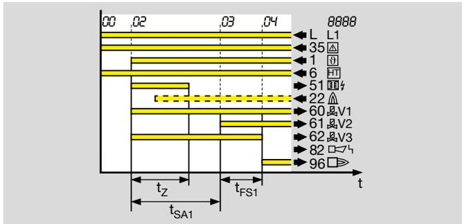
Sinkt die Temperatur im Ofenraum unter 750 °C, so muss der HT-Eingang spannungsfrei geschaltet werden und somit der Ofen mit Flammenüberwachung betrieben werden.
