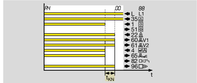
Parameter A043 = 0: Aus. Es findet kein Nachlauf statt. Bei der Ein/Aus-Regelung wird die Gasseite durch ein schnell schließendes Gasventil unverzüglich geschlossen. Die Luftseite schließt langsamer. Die dabei einströmende Luft erhöht den O<sub>2</sub>-Anteil im Verbrennungsraum.
