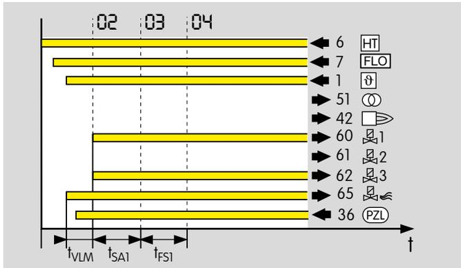
Die Abfrage des Luft-Druckwächters und der Position des IC erfolgt über die Klemme 36 der BCU.
