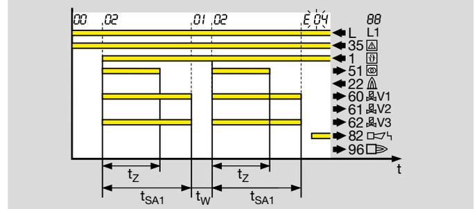
Bildet sich während des Anlaufs keine Flamme, sodass am Ende der Sicherheitszeit  $t_{SA1}$  kein Flammensignal erkannt wird, schließt die BCU die Gasventile und führt den Anlauf erneut durch. Jeder erneute Anlauf beginnt mit dem parametrisierten Anlaufverhalten.
