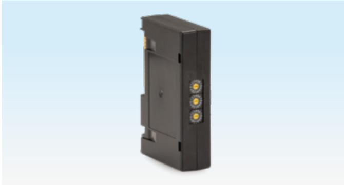
Le module bus BCM 400 sert d'interface de communication pour les appareils de la série BCU 4 (2019) dans le cadre d'une intégration à une communication par bus terrain (PROFIBUS, PROFINET ou EtherNet/IP). L'interconnexion via le bus terrain permet de commander et de contrôler le BCU depuis un système d'automatisation (par ex. API).
