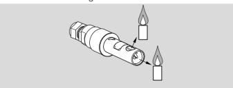
Über die Sichtöffnungen im Sondenkopf kann die UV-Röhre seitlich oder frontal auf die Flamme ausgerichtet werden.
