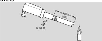
Die Montage erfolgt über den (mitgelieferten) Adapter mit integriertem Wärmeschutz aus Quarzglas an ein ½" Sichtrohr. Das Sichtrohr sollte auf das erste Flammendrittel ausgerichtet sein, da hier im Allgemeinen die stärkste UV-Strahlung vorliegt. Das Stahlrohr sollte innen blank sein.
