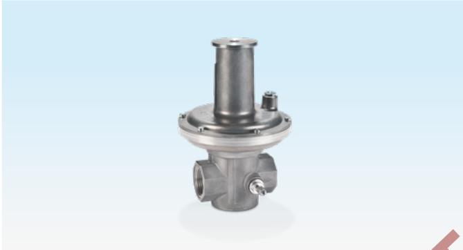
Ablaseventil zum Abbau kurzzeitig auftretender Druckstöße in Regelstrecken, um ein ungewolltes Ansprechen des Sicherheitsabsperrentiles JSAV zu verhindern. Ein zu hoher Druckanstieg bei auftretenden Leckgasmengen infolge nicht dicht schließender Gasdruckregelgeräte wird vom VSBV abgebaut.
