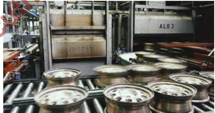
Aluminium-Aushärteofen mit Gleichdruckreglern zur Luftmanagementsicherung
