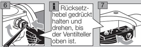
**i** Rücksetzhebel gedrückt halten und drehen, bis der Ventilteller oben ist.
