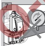
**8** Откройте газовый клапан запальной горелки.
