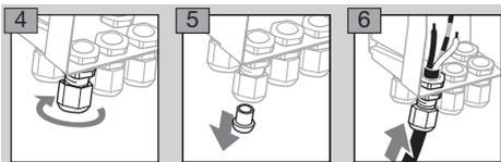
**7** Benutzte Anschlussverschraubungen festschrauben. Anzugsdrehmoment max. 3,5 Nm.
