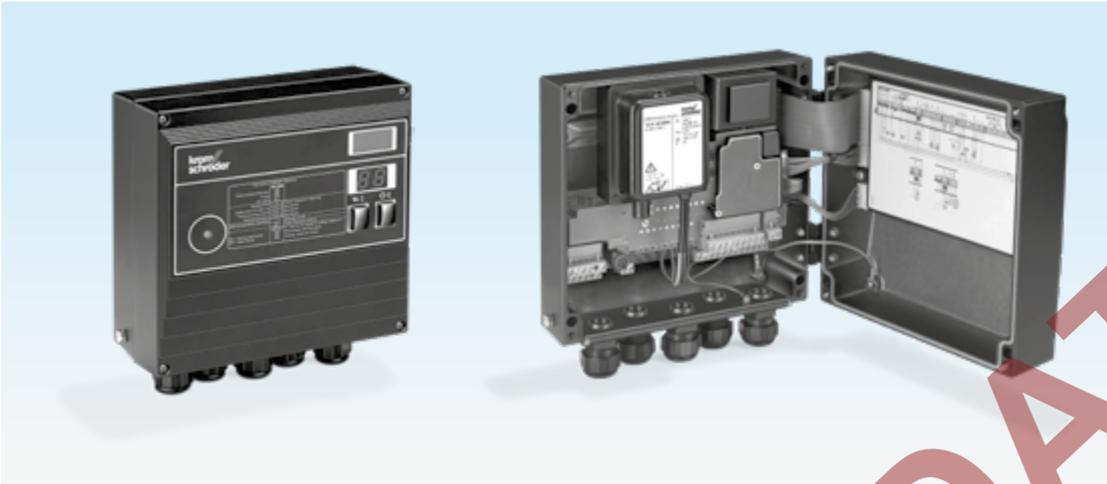
*El BCU reúne en una compacta caja metálica los componentes funcionalmente afines: control de quemador, transformador de encendido, operación manual/automática e indicación de estados operativos y de avería.*
