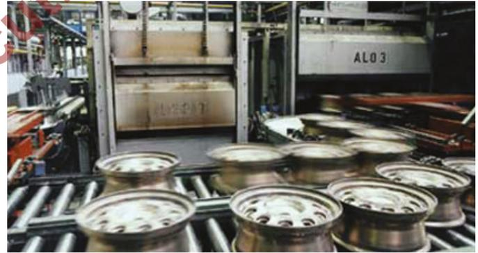
Horno de endurecimiento de aluminio con reguladores de proporción para protección de la falta de aire
