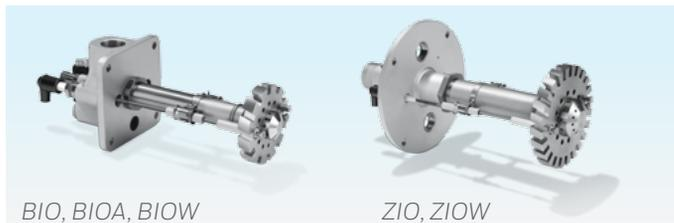
Le gaz combustible est alimenté par le raccord gaz et le tuyau gaz vers la tête du brûleur. La bride de raccordement gaz renferme le verre-regard, la vis de mise à la terre et les bougies électrodes à embout coudé.
