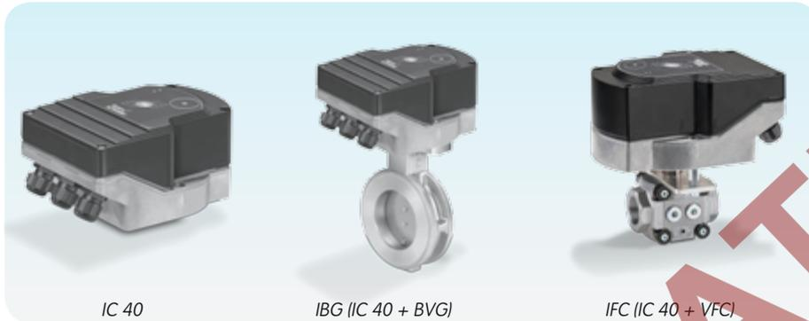
Le servomoteur IC 40 est conçu pour toutes les applications exigeant une rotation exacte située entre 0° et 90°. Il peut être monté directement sur les vannes papillons BVG, BVGF, BVA, BVAf, BVH, BVHS ou sur la vanne de régulation linéaire VFC afin de régler le débit de gaz et d'air des brûleurs gaz.
