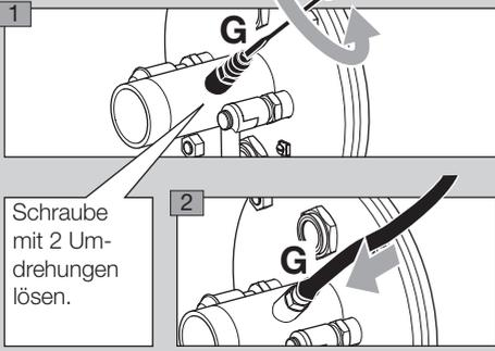
Schraube mit 2 Umdrehungen lösen.
