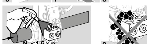
**10** Sperr av gassledningen like bak magnetventilen.
