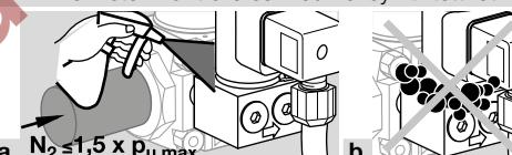
Kontroller bypass-/tenngassventilens inngangs- og utgangsside med hensyn til tetthet.
