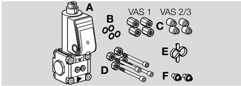
**A** 1 x valvola di bypass/del gas pilota VAS 1,
