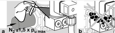
Controllare la tenuta della valvola di bypass/del gas pilota in entrata e in uscita.
