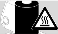
→ Utilizzare un cavo termoresistente (> 80 °C).
