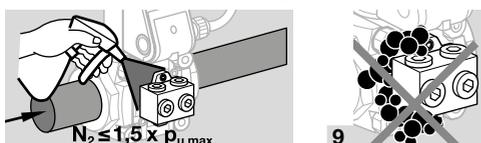
**10** Bloccare la tubazione del gas subito a valle della valvola elettromagnetica.
