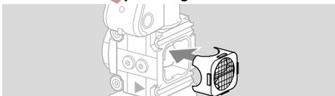
→ Se in un secondo momento si monta il regolatore di pressione VAD/VAG/VAV 1 a monte della valvola elettromagnetica gas VAS 1, sull'uscita dello stesso occorre inserire un orifizio calibrato DN 25 per il segnale di retroazione con foro di uscita  $d = 30$  mm (1,18"). In caso di regolatore VAX 115 o VAX 120, l'orifizio calibrato DN 25 per il segnale di retroazione va ordinato separatamente e montato a posteriori, n° d'ordine 74922240.
