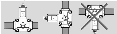
→ Posizione di montaggio: attuatore elettromagnetico nero in posizione verticale od orizzontale, non capovolto. In ambiente umido: solo con attuatore elettromagnetico nero posto in verticale.
