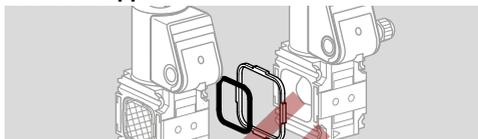
→ Se si montano insieme due dispositivi (regolatori o valvole), occorre installare un telaio di supporto con guarnizione a doppio blocco. N° d'ordine per set di tenuta: dimensione 1: 74921988, dimensione 2: 74921989, dimensione 3: 74921990.
