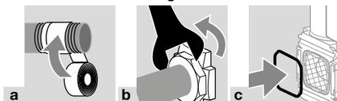
→ Occorre installare un O-ring e un filtro a rete (figura c).
