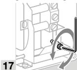
17 Deckel wieder aufsetzen und festschrauben.
