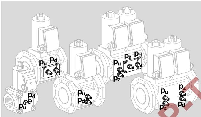
La pression amont  $p_u$ , la pression intermédiaire  $p_z$  et la pression aval  $p_d$  peuvent être mesurées des deux côtés au niveau des prises de pression.
