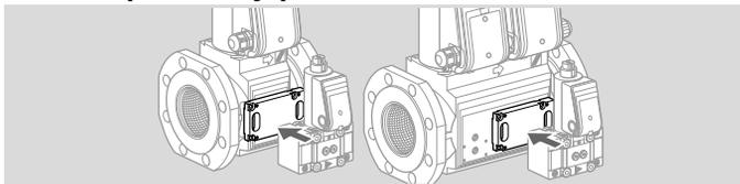
Pour le raccordement de la vanne de by-pass/pilote VAS 1.
