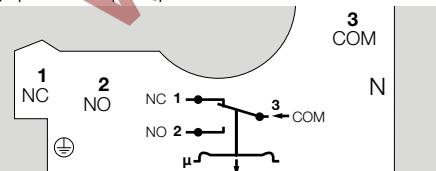
У датчиков с настройкой избыточного давления удалите находящийся в приборе шаблон и произведите подключение в соответствии с выгравированной схемой электроподключения.
