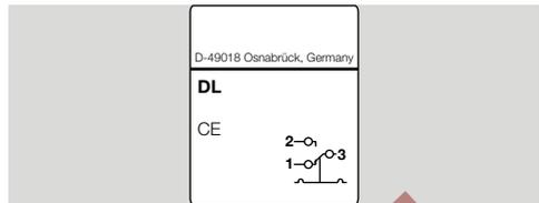
Presión de entrada máx. = presión de resistencia, tensión de la red, temperatura ambiente, grado de protección: ver placa de características.
