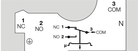
Pour la plage de réglage positive, ôter ce gabarit et procéder au câblage en se reportant au plan de raccordement gravé.
