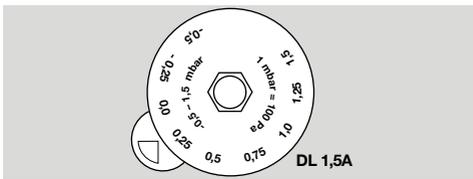
Pour la plage de réglage négative, le gabarit placé dans l'appareil présente une description du raccordement.
