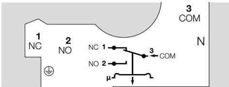
Im positiven Einstellbereich die im Gerät liegende Schablone entfernen und nach dem gravierten Anschlussplan verdrahten.
