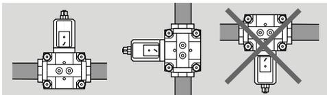
→ Montasjeposisjon: Sort magnetaktuator loddrett stående til vannrett liggende, men ikke på hodet. Ved fuktige omgivelser: Sort magnetaktuator kun stående loddrett.
