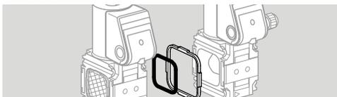
→ Dersom to armaturer (regulatorer eller ventiler) monteres sammen, må det monteres en holderamme med dobbeltblokketning. Best.-nr. for tetningssett: konstruksjonsstørrelse 1: 74921988, konstruksjonsstørrelse 2: 74921989, konstruksjonsstørrelse 3: 74921990.
