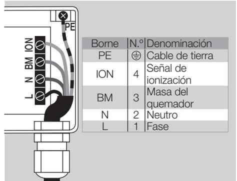
Esquemas de conexiones de controles de quemador
