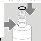
→ Má-li daný přístroj O-kroužek na tomto místě (šipka), pak se pohon vymění, jak zde popsáno: VAN 1: použít všechna těsnění ze sady adaptérů pohonu. VAN 2: použít malé těsnění a jen jedno velké těsnění ze sady adaptérů pohonu.
