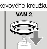
d Vsunout těsnění pod druhou drážku.
