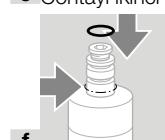
→ Mevcut cihaz gösterilen yerde (ok işaret) O-ring contaya sahip ise tahrîgi burada tarif edildiği gibi değiştirin: VAN 1: Bobin adaptör setinde yer alan tüm contaları kullanın. VAN 2: Bobin adaptör setinde yer alan küçük contayı ve tek bir büyük contayı kullanın.
